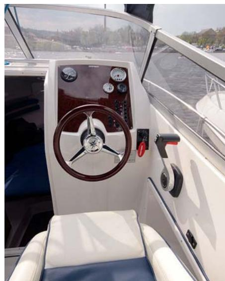
Na jednoduché palubní desce najdeme rychloměr, otáčkoměr a ukazatel stavu paliva.
